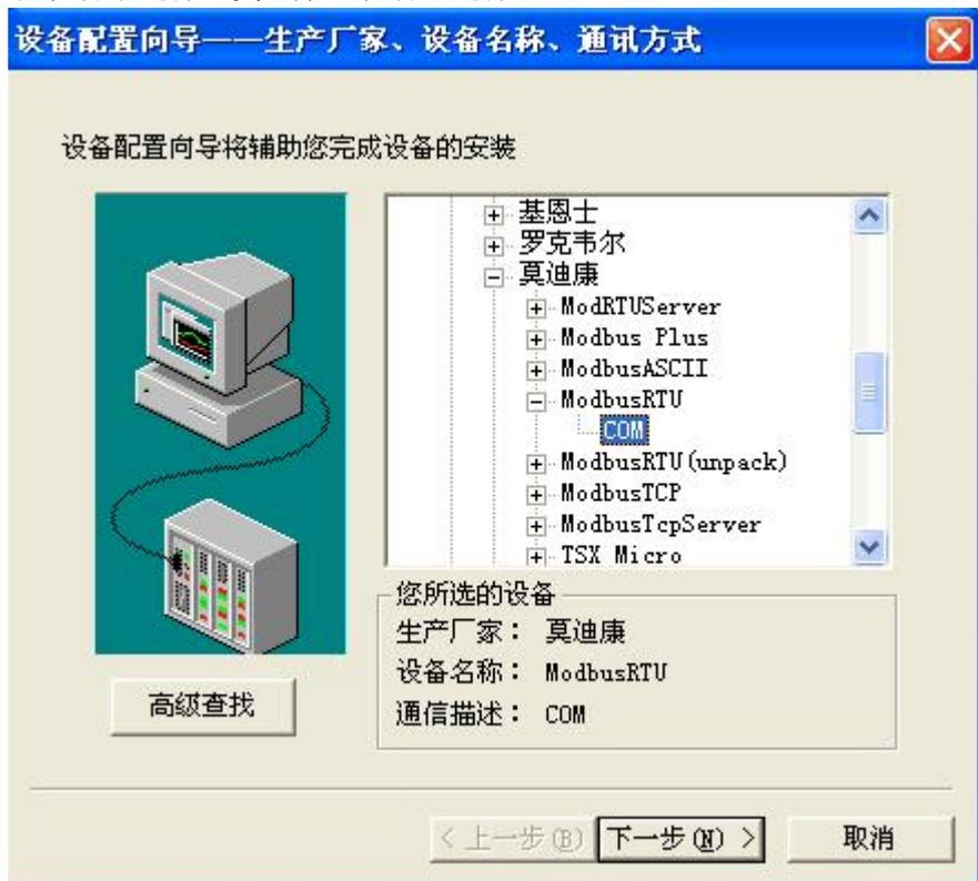
配置向导，选择计算机所连采集模块的COM口（采集模块默认9600 N 8 1）：
